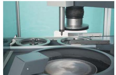
7. Подготовленный держатель с образцами помещается на конвейерную ленту, где принимается металлографом для дальнейшего исследования на микроскопе
