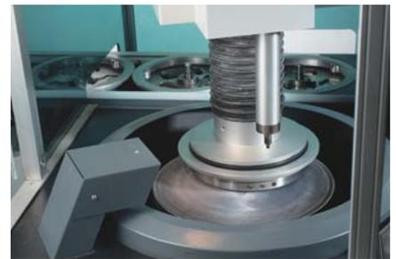
6. После тонкого шлифования держатель с образцами перемещается на полирование
