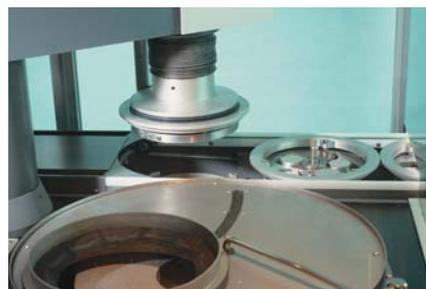
3. Держатели с образцами забираются с конвейерной ленты специальным вращателем образцов
