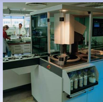
MAPS это непревзойденное решение для автоматической подготовки материалаграфических образцов. Модульная система, которая комплектуется в точности под задачи пользователя. MAPS осуществляет полный процесс подготовки – от выравнивания до конечной чистки и сушки. Производится точный контроль расхода абразивов и лубрикантов, что позволяет получить превосходное качество образцов и воспроизводимость результатов.
