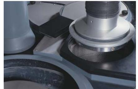
5. После шлифования, держатель с образцами помещается в камеру очистки
