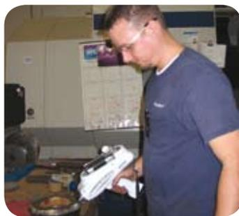
S1 Turbo<sup>SD</sup> LE для определения химического состава и марок сплавов
