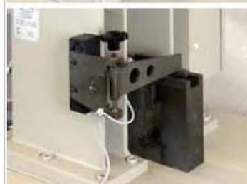
Центрирующее устройство для правильной установки образца
