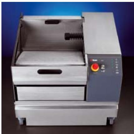
*В AbraPlan-20 находится камера для рециркуляционного охлаждающего блока, который также может быть расположен рядом со станком.*
