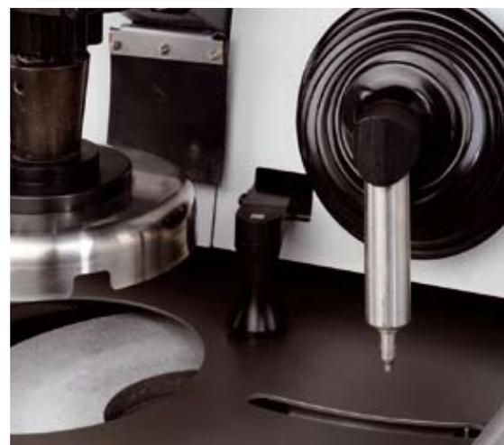
*Автоматическая правка поддерживает прекрасную плоскостность и режущую способность шлифовального камня*
