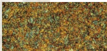
Мартенситная сталь, травленная, 350х
