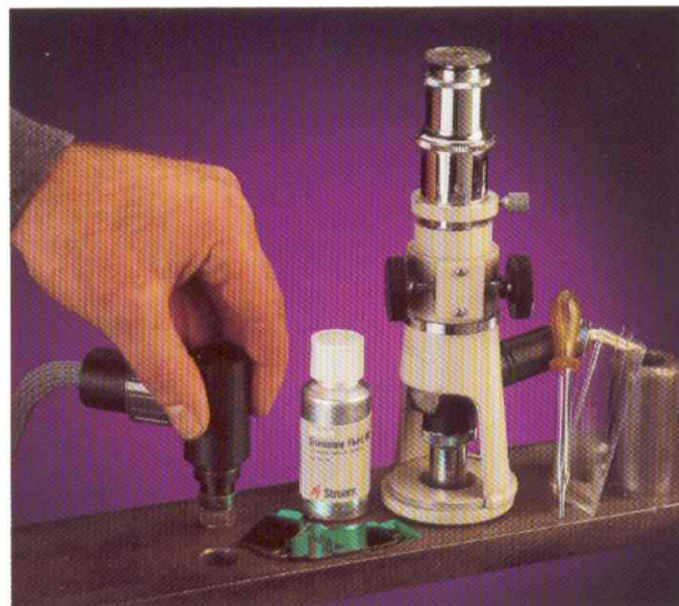
Портативный микроскоп PSM-2 и Transcopy - необходимые инструменты для неразрушающей материаловедения
