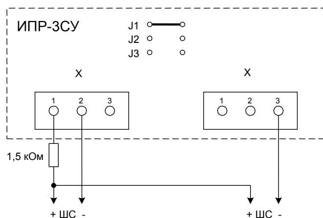
при имитации теплового датчика
