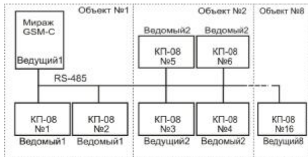
Рис.1 Структура интегрированной системы охраны на базе оборудования серии «Мираж-GSM»
