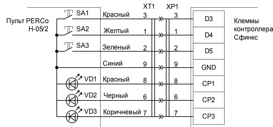
Рисунок 32. Подключение пульта управления PERCo H-05/2 с разъемом
