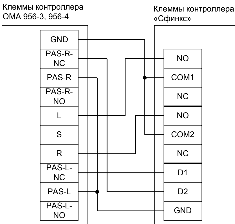
Рисунок 37. Подключение турникета ОМА с контроллером ОМА 956-1/2/3/4 .
