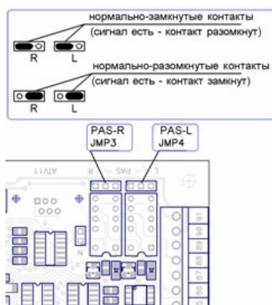
Рисунок 34. Перемычки JMP3 и JMP4 контроллера ОМА-DD.958.
