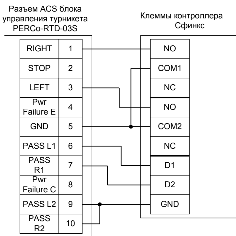
Рисунок 29. Подключение турникета PERCo-RTD-03S.
