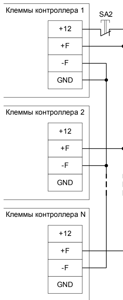
Рисунок 15. Подключение линии пожарной сигнализации к нескольким контроллерам, вариант 2.
