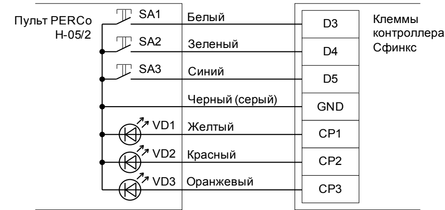
Рисунок 31. Подключение пульта управления PERCo H-05/2 без разъема.
