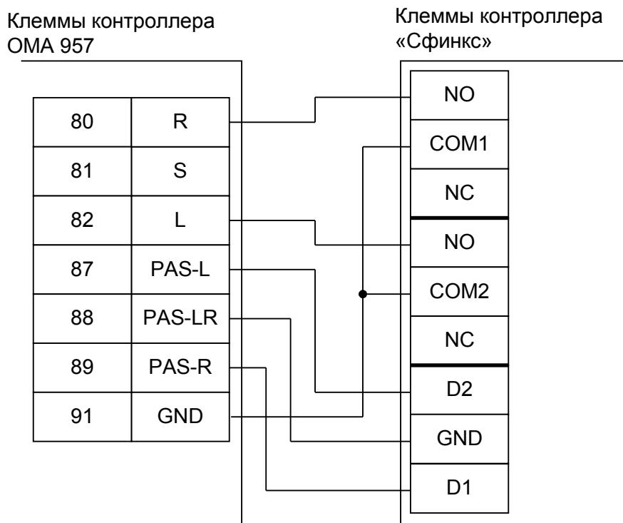
Рисунок 35. Подключение турникета ОМА с контроллером ОМА 957.
