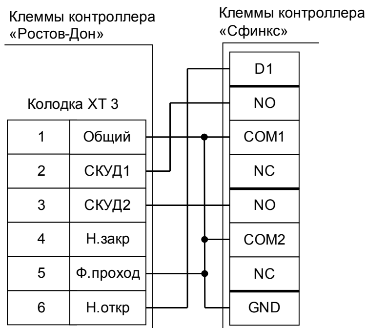
Рисунок 43. Подключение турникетов и калиток «Ростов-Дон», вариант №4.
