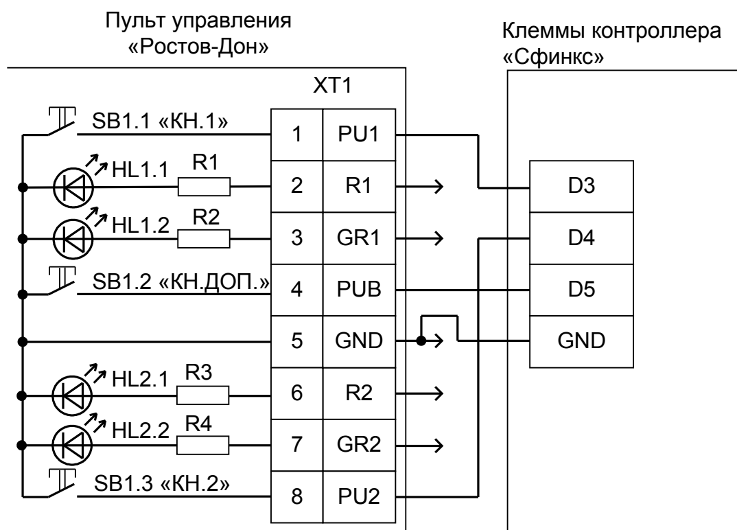
Рисунок 44. Подключение пульта управления Ростов–Дон.
