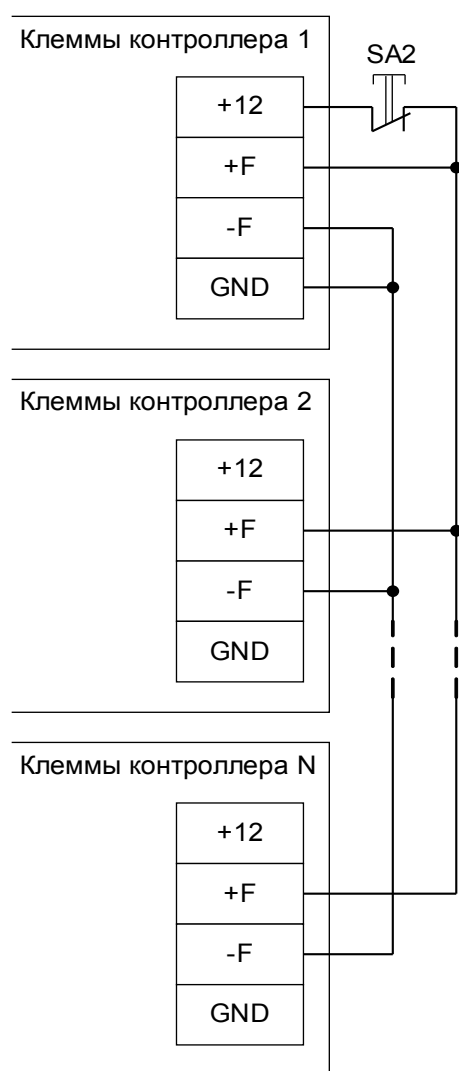
Рисунок 13. Подключение линии пожарной сигнализации к нескольким контроллерам, вариант 2.
