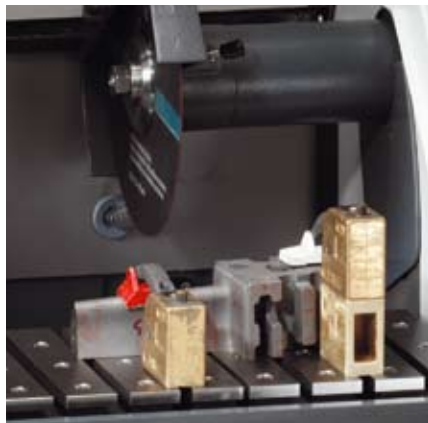
Для фиксации деталей неправильной формы применяется вертикальная зажимная система
