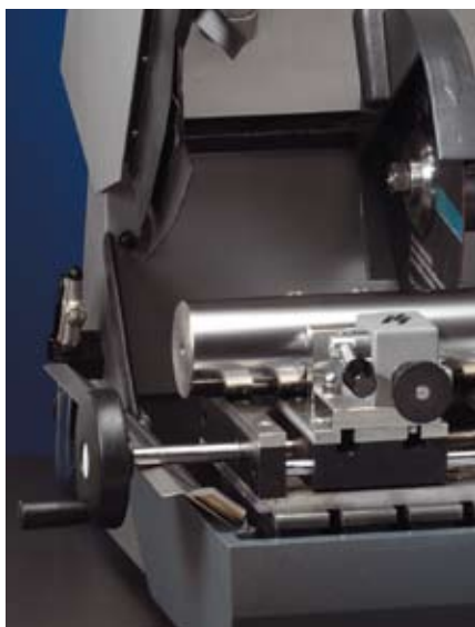
Регулируемый отрезной столик для параллельной резки
