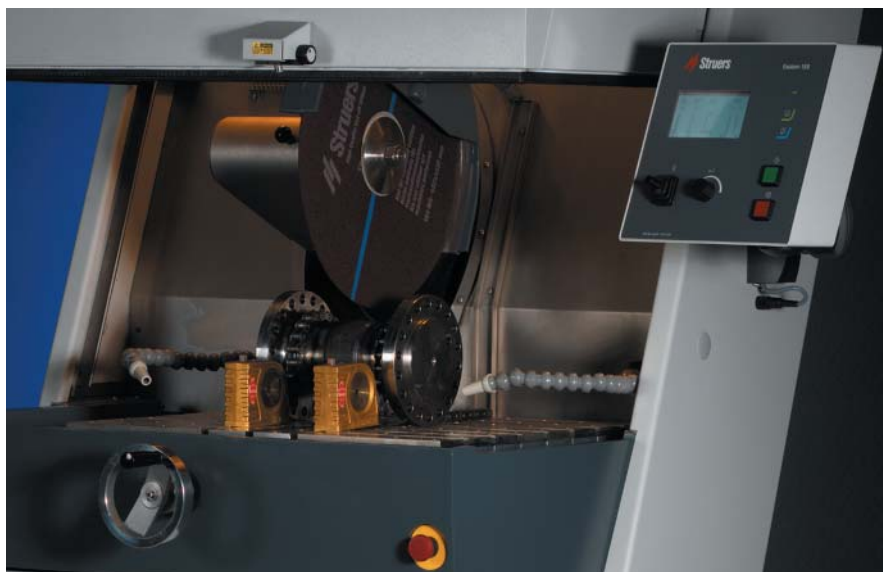
Две простых кнопки в сочетании с большим дисплеем образуют шарнирную панель управления
