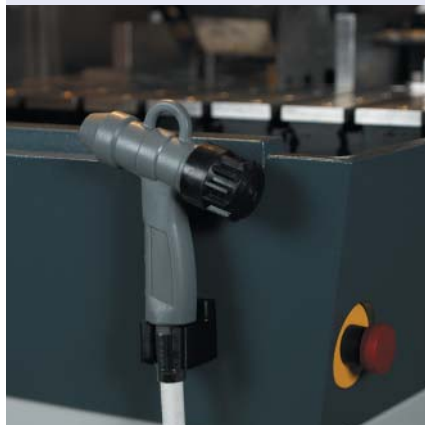
На Exotom-150 промывочный пистолет расположен вне отрезной камеры
