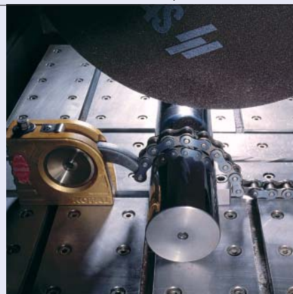
Цепной держатель для больших неправильных образцов
